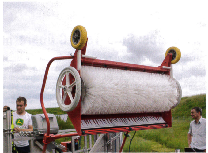
Die Bürste besteht aus Kunststoff und wird mit Wasserdruck angetrieben.
