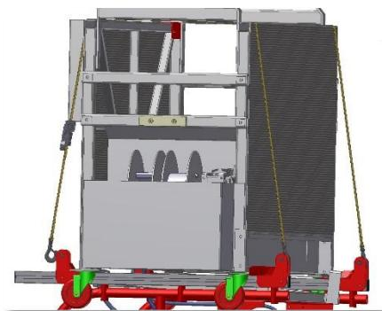
In Folge werden die zwei Zurrurte um die Gondel gelegt und die vier Karabinerhaken mit den Anschlagpunkten (M12-Schrauben) der Gondelauflagen verbunden.
