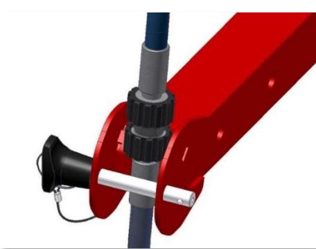
Der anschließend eingesetzte Kugelsperrbolzen (12) verhindert dann das Herausspringen der beiden Schläuche aus dem Teleskopausschub des Schlauchabstand-Teleskops (1). Gleichzeitig erzeugt der Kugelsperrbolzen (12) eine Durchrutschsperre für den 50 m Zuleitungsschlauch (11).
